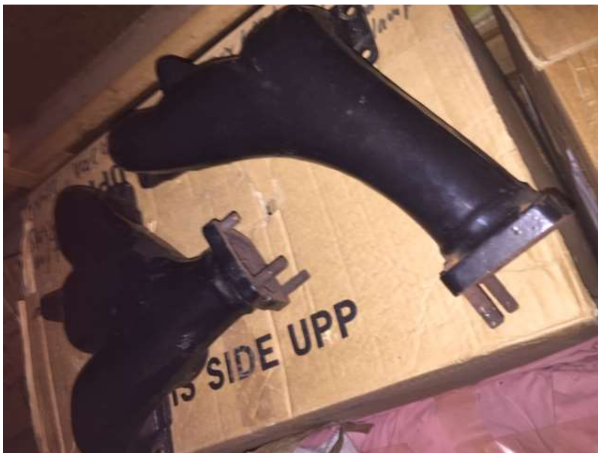
Bild 31. Så här fina blev grenrören efter emaljering hos Nya Fabriksverken. Foto: Leif H Andersson.
