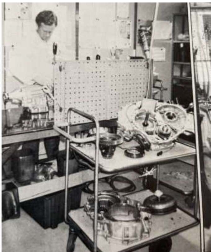
Bild 91. Från tidning 104 feb 1990 sid 21. Dan Stålebo jobbar med monteringen av en automatväxellåda. Foto: Okänd.
