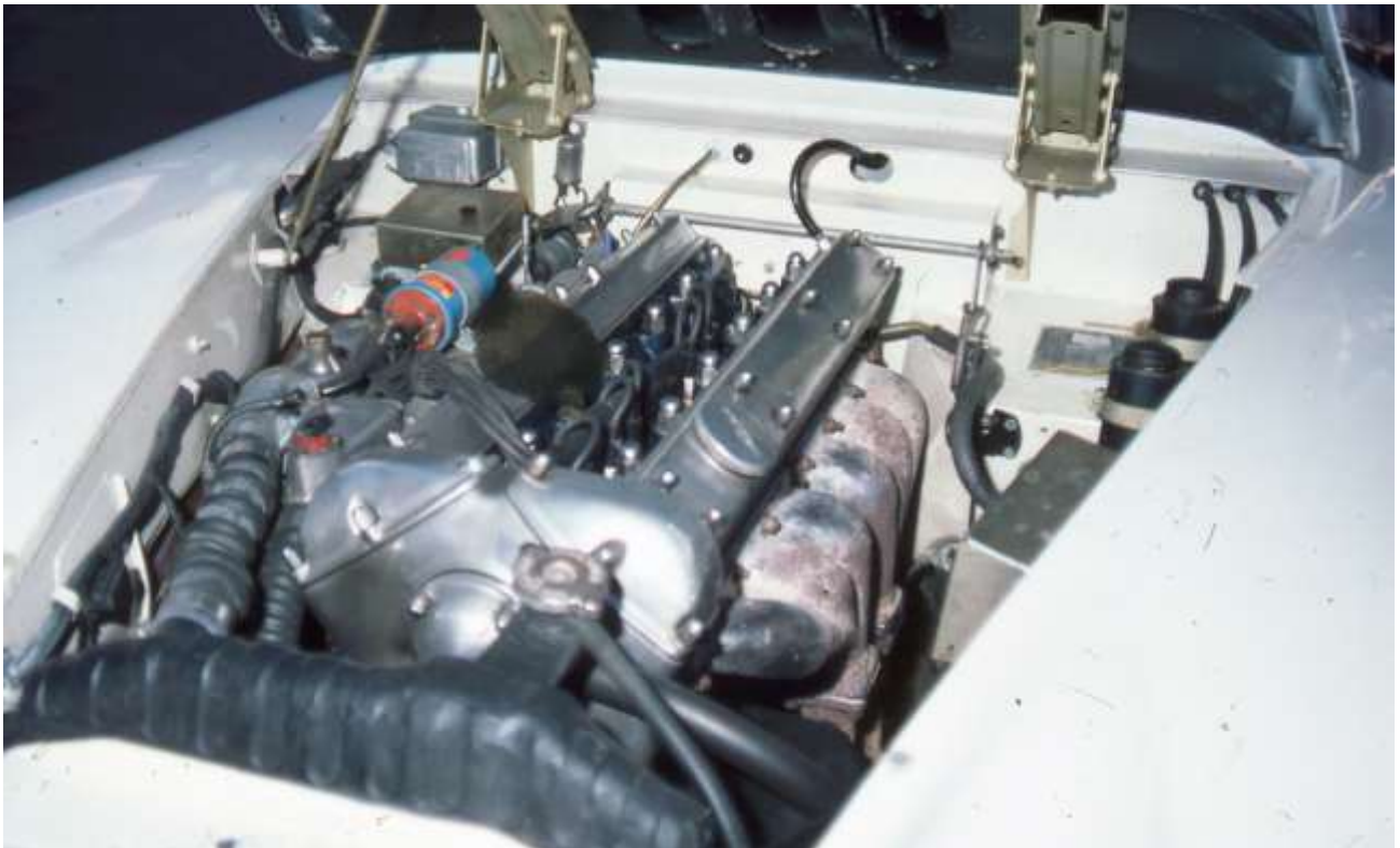
Bild 74 E. Motorn försedd med B-topp. Sen blev det Weberförgasare. Foto: Leif H Andersson.
