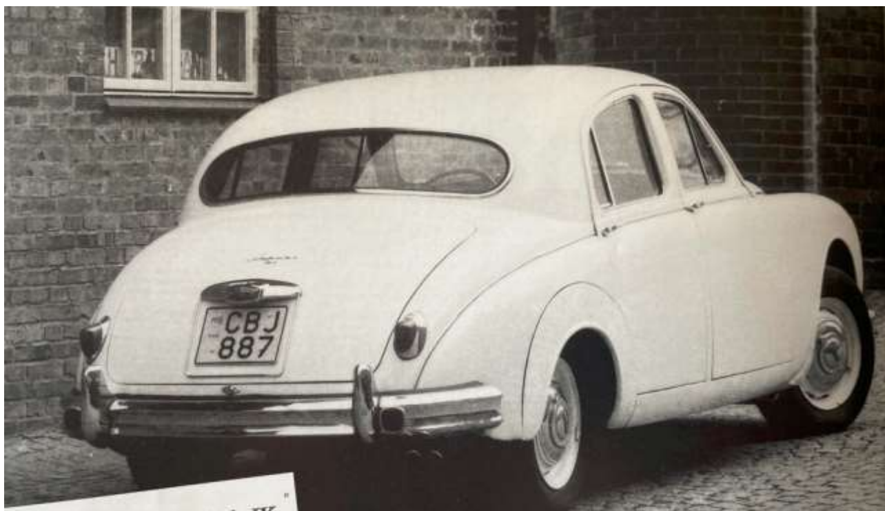
Bild 172. Från tidning 136 nr 3 1995 sid 26. Fina linjer på Mk I med lite mindre bakruta än på efterföljaren Mk II. Också lite enklare bromsar då Mk I:ans trumbromsar övergivits och ersatts med skivbromsar runt om. Foto: Peter Haventon.
