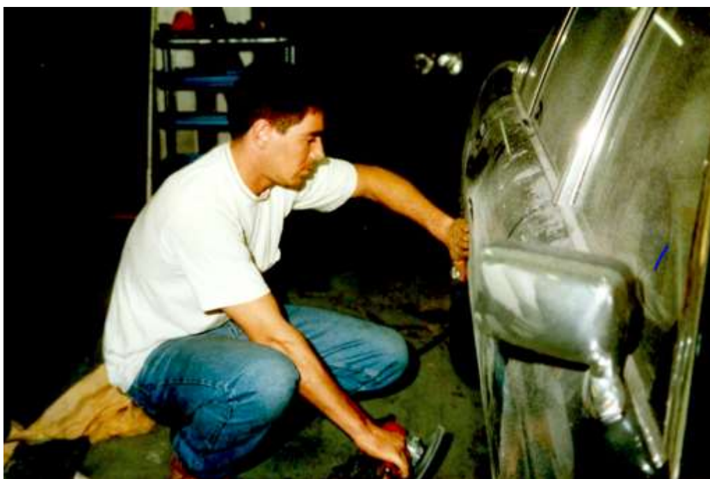
Bild 55. Martin Short jobbar med den avslutande slipningen på en XJ 6. Foto: Leif H Andersson.
